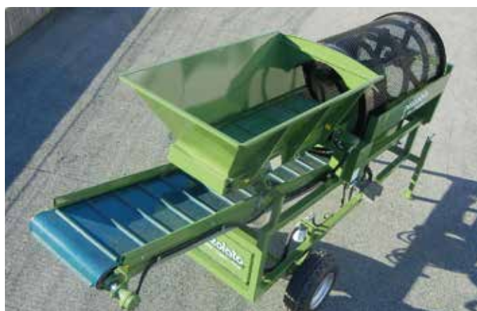
Nastro di scarico materiale sotto vaglio
