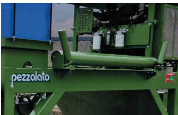
Rulli a "V" per distendere un telo protettivo per l'andana
