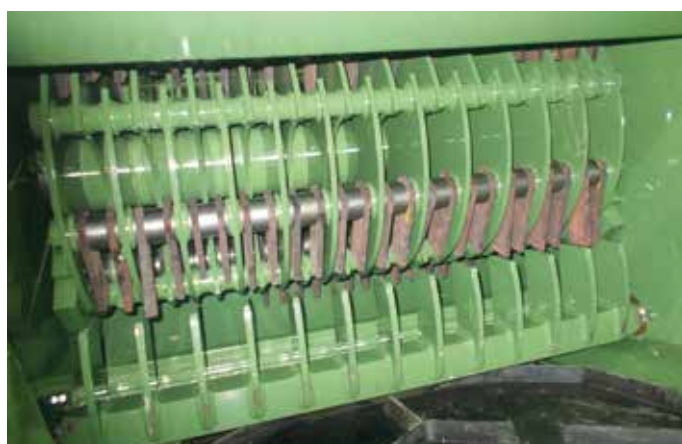
Rotore S 9000 con martelli mobili e contromartello
