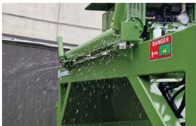
Rampa da 2" con ugelli per distribuzione liquidi
