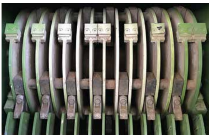
Rotore S 10000 con martelli mobili e contromatello
