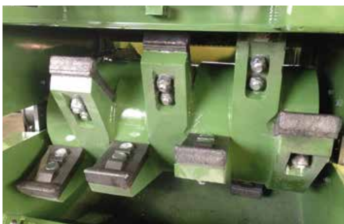
Rotore MF 10000 con martelli fissi
